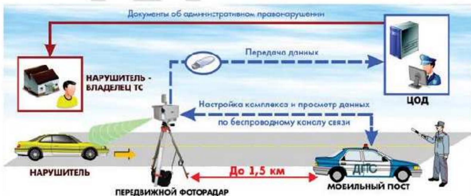
Рисунок 10 Принципиальная схема контроля нарушений
