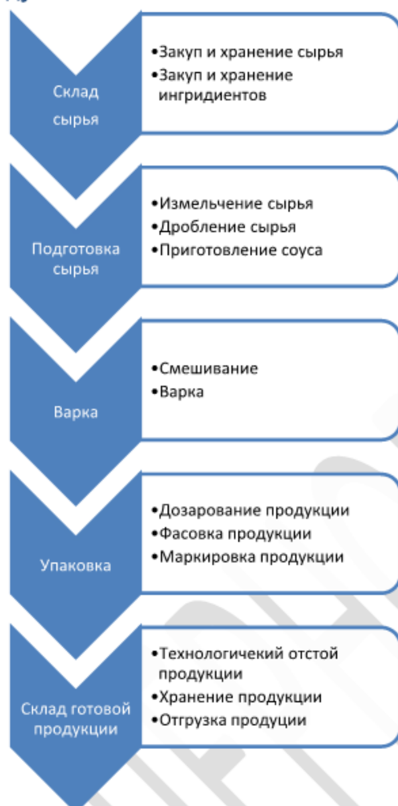
Рисунок Принципиальная схема технологии производства продукции
